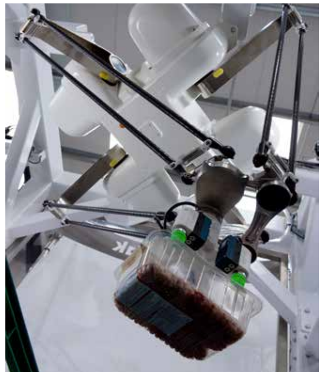
For maksimal pakningsfleksibilitet er linjen også udstyret med Omrons PackXpert-software, som gør det muligt at programmere placeringen og pakkerækkefølgen for hver enkelt bakke.
