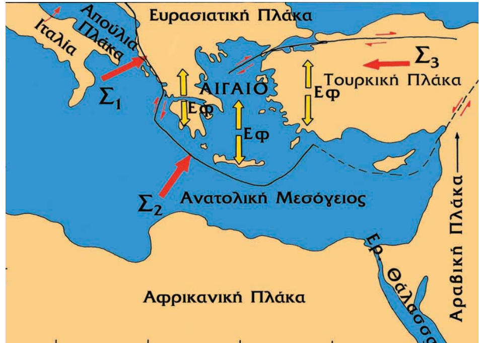
Εικ. 1.36. Σχηματική αποτύπωση των δυνάμεων που ασκούνται στη λιθόσφαιρα του Αιγαίου. Οι συμπιεστικές δυνάμεις \Sigma_1 , \Sigma_2 και \Sigma_3 που ασκούν οι γειτονικές λιθосφαιρικές πλάκες στη μικρόπλακα του Αιγαίου απεικονίζονται με τα κόκκινα βέλη. Οι εφελκυστικές δυνάμεις που ασκούνται στην κάτω επιφάνεια της λιθόσφαιρας με τα κίτρινα βέλη (Παπαζάχος Β., 1989).
