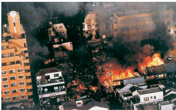
Εικ. 2.28. Hanshin - Kobe Ιαπωνία, σεισμός 1995. Οι φωτιές ξέσπασαν αμέσως μετά το σεισμό, λόγω διαρροών σε σωλήνες του αερίου για οικιακή χρήση. Έκαιγαν για 24 ώρες αναγκάζοντας τους επιζώντες να εγκαταλείψουν το κεντρικό Kobe αφήνοντας πίσω αγνοούμενους, συγγενείς και φίλους. Πολλά από τα ξύλινα σπίτια της πόλης καταστράφηκαν από τη φωτιά ενώ οι πυροσβέστες συνάντησαν μεγάλες δυσκολίες στην κατάσβεσή της εξαιτίας της έλλειψης νερού.
