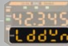
Equippé d'un contrôleur de durée de vie avertissant de la détérioration de la diode laser
