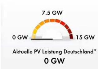
\* Hochgerechnete, momentane Leistung aller lt. Bundesnetzagentur am Stichtag 31.08.2010 installierten PV-Anlagen mit insgesamt 14.68 GW Nennleistung.
