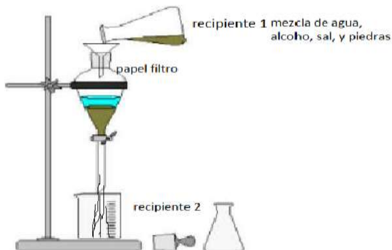
Figura 4: Montaje con embudo de separación.
