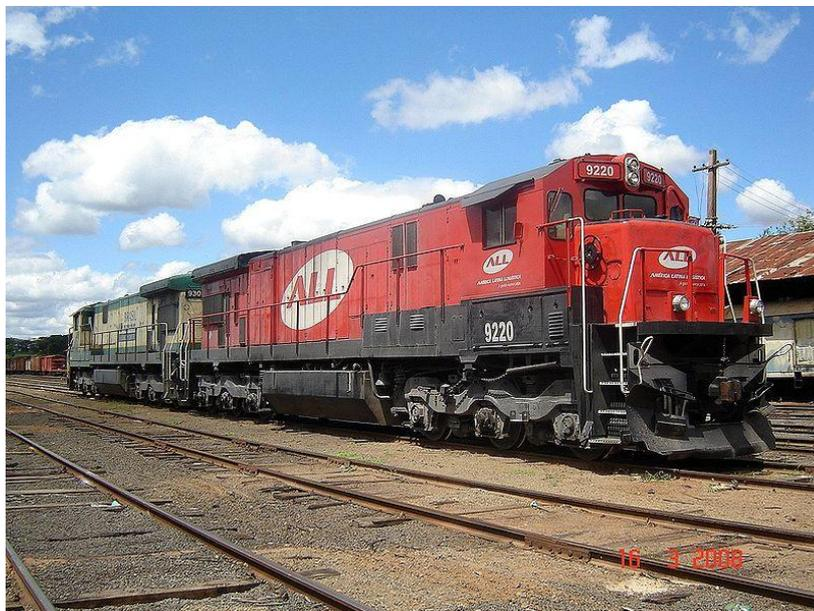
**Figura 2.3.2.2-1: Foto de um modelo de locomotiva GE C 30-7.**
