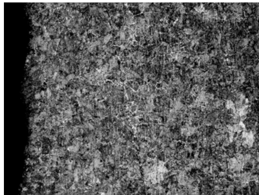
Рис. 2. Разорванная карбидная сетка в структуре образцов, отожженных после цементации по режиму № 1 (×200)
