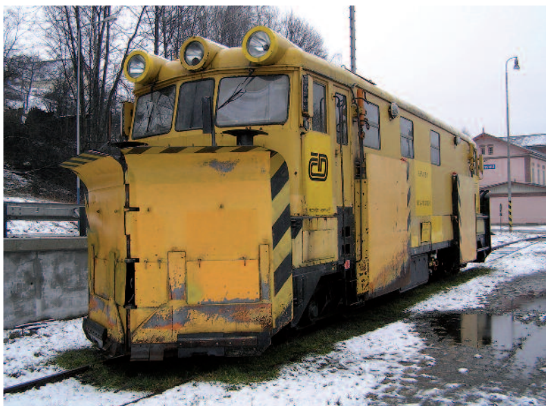
Sněhový pluh KSP 411-S1 se již mnohokrát osvědčil při zimní údržbě trati
