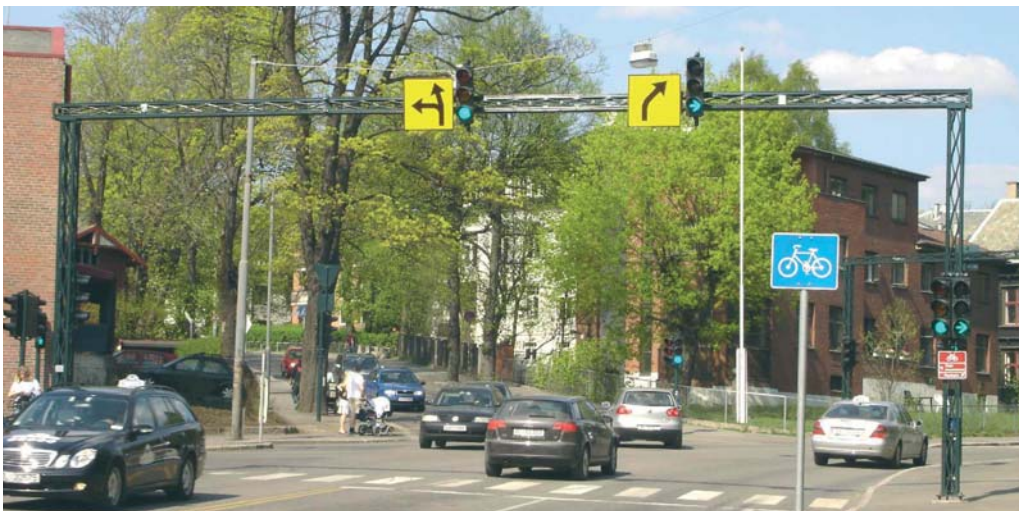
Figur 2-74: Eksempel på bruk av gitterportal.
