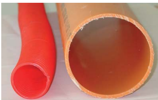
Figur 2-52: 50 mm flexirør og 110 mm PEH-rør.
