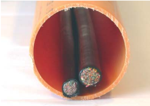
Figur 2-58: Samkjøringskabel (50 og 100 par) i 110 mm rør.
