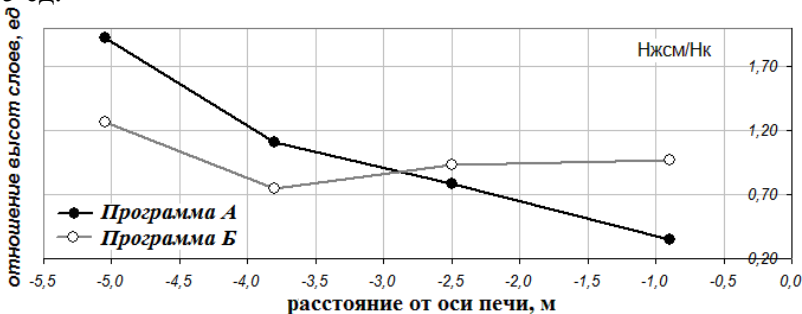
Рис. 6.17. Радиальное распределение средней величины отношения высот слоев железосодержащих материалов ( H_{жс} ) и кокса ( H_K ) за цикл при использовании программ загрузки А и Б в периодах I–IV
