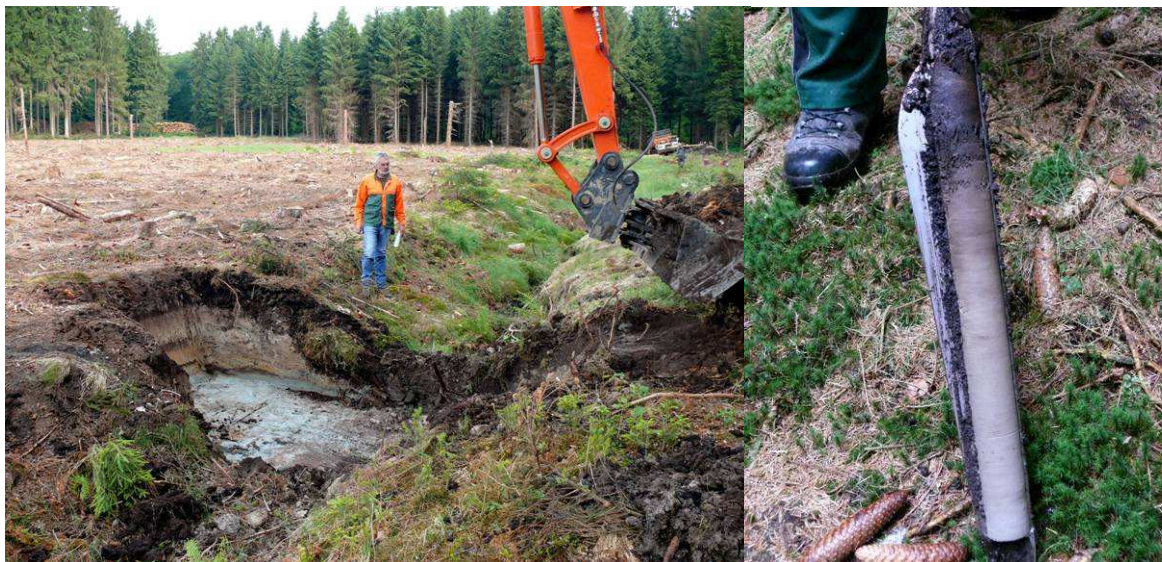
Abb. 1: Freilegung eines typischen Molkebodens im Projektgebiet „Teichwiesen“ (linkes Bild) und Bohrkern eines Molkebodens (rechtes Bild).
