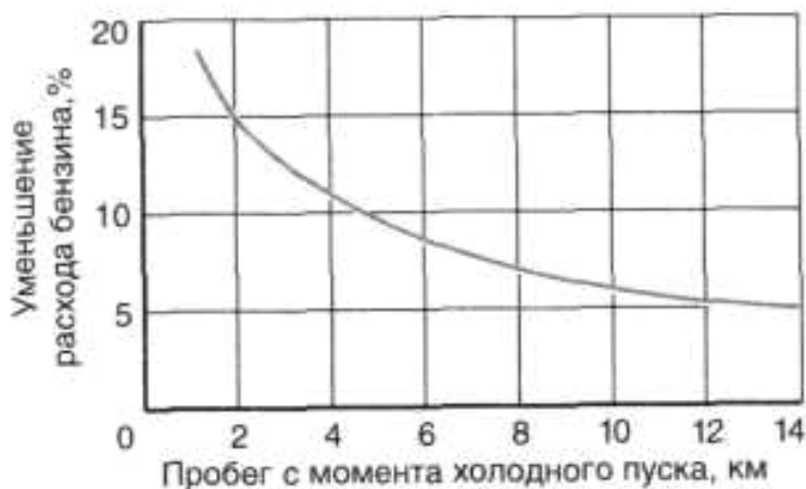
Рисунок 11 – Снижение расхода бензина при движении автомобиля по мере прогрева двигателя до рабочей температуры
