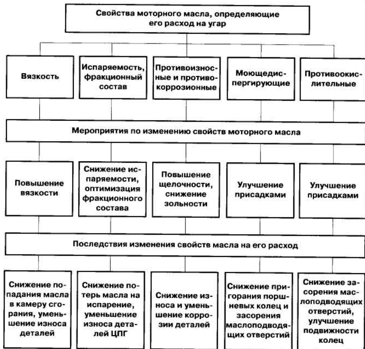
Рисунок 16 – Схема физико-механических свойств моторного масла на его потери и угар
