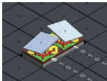
デジタル入力に基づき、ミラーが2方向へスイッチ動作します。
