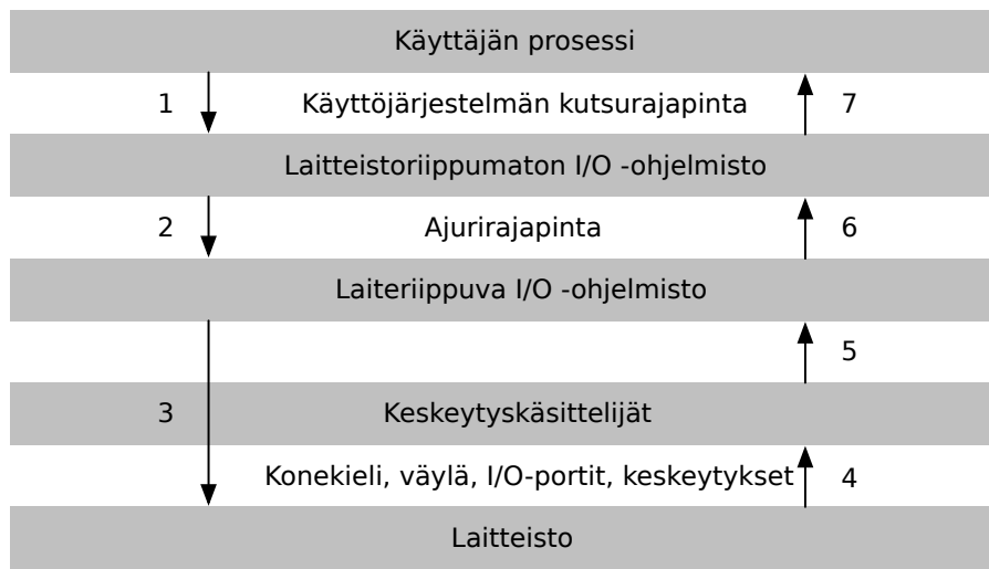
Kuva 30: I/O -operaatioon osallistuvat kerrokset, niiden väliset rajapinnat, ja operaation suoritusvaiheet ja osapuolet aikajärjestyksessä (1–7).
