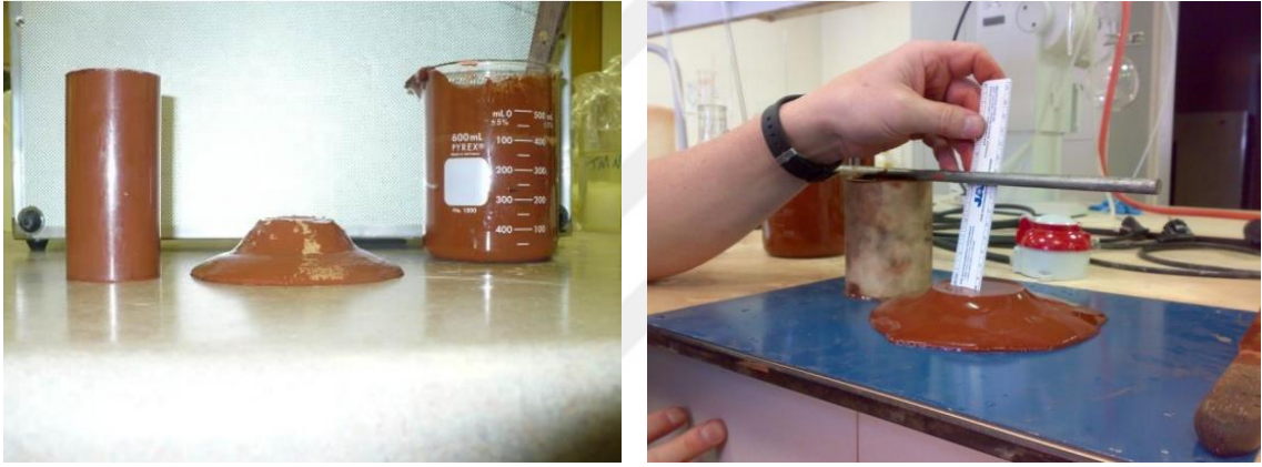
Şekil 6.6. Laboratuvarda yapılan kırmızı çamur slump testi görüntüsü
