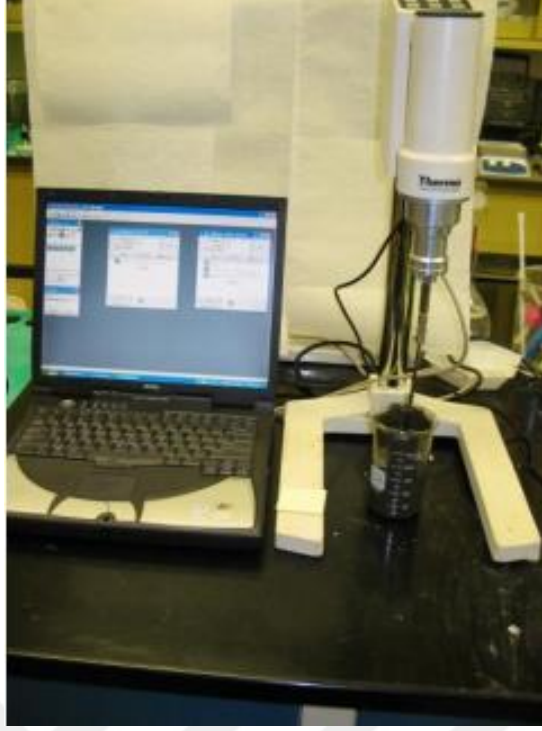
Şekil 6.9. Haake VT550 vizkozimetre ile yapılan akma gerilmesi deneyi
