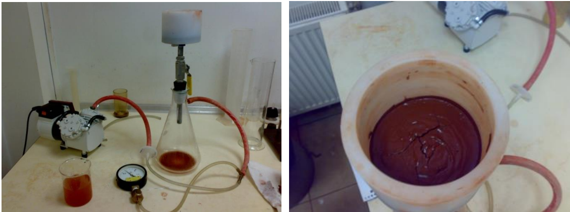
Şekil 6.13. Vakum filtrasyon deney düzeneği
