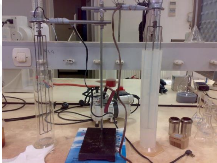
Şekil 6.3. Karıştırıcı mekanizmalı deney düzeneği
