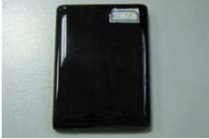
Şekil 3.11. Kırmızı çamurdan cam-seramik üretimi (Perez-Villarejo ve ark., 2012)
