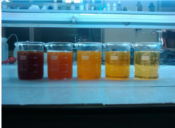
Şekil 6.29. Filtrasyon esnasında farklı zamanlarda alınan filtrat numuneleri.
