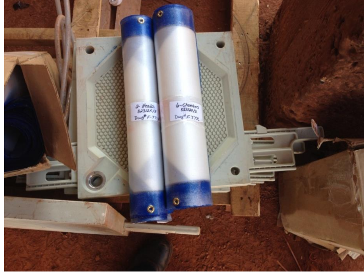
Şekil 6.42. Polypropilen filtre bezi ve kullanılan plakalar
