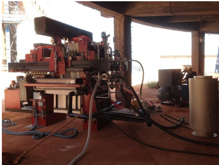
Şekil 6.31. Kırmızı çamur yıkama devresinde montajı yapılan pilot ölçekli pres filtre
