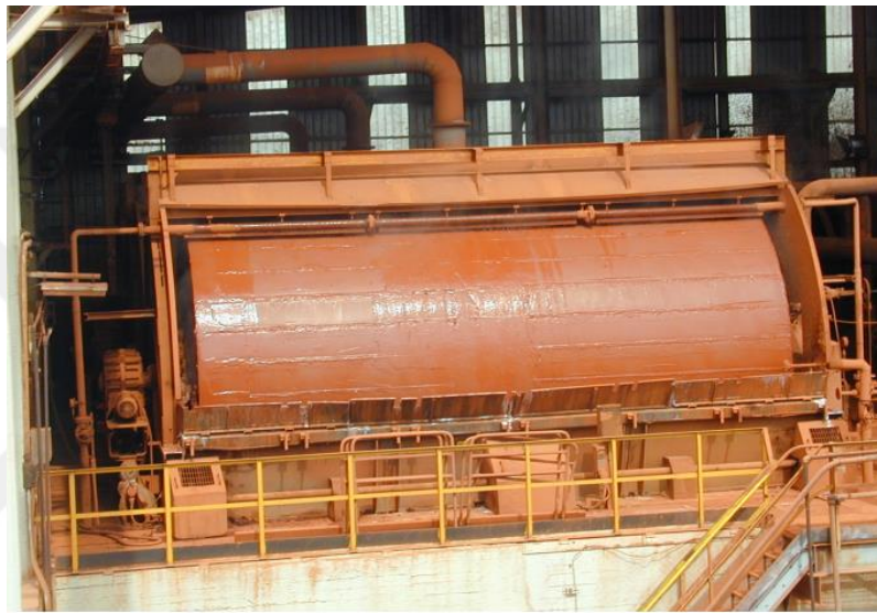
Şekil 4.7. Vakumlu tamburlu (Drum) filtre görüntüleri (Langeloh ve ark., 2005)
