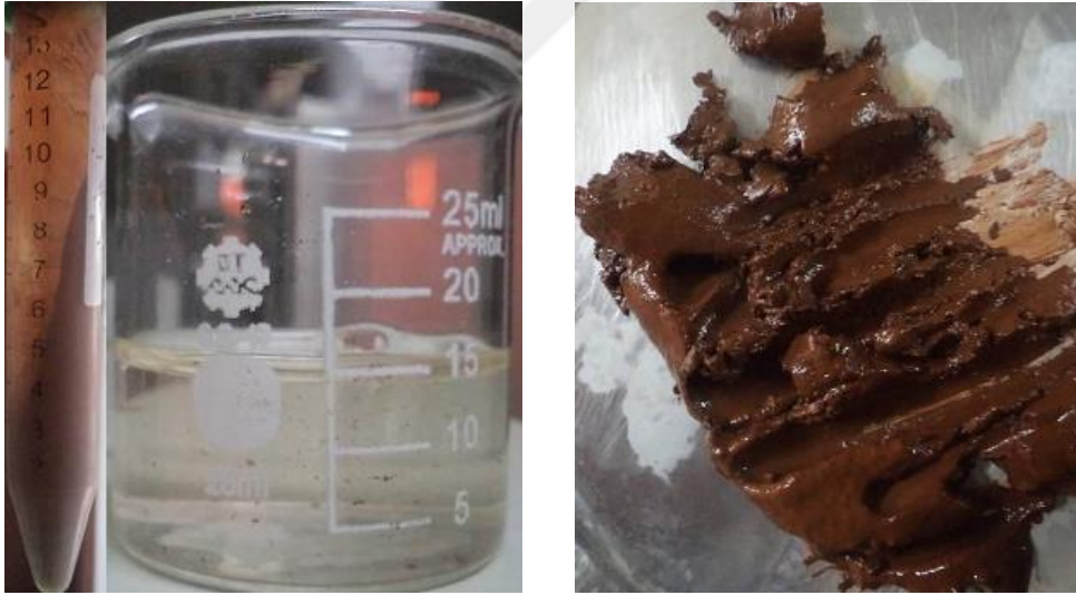
Şekil 6.23. Anyonik flokülant eklenmiş numunenin santrifüj sonrası sentrat ve kek görüntüsü
