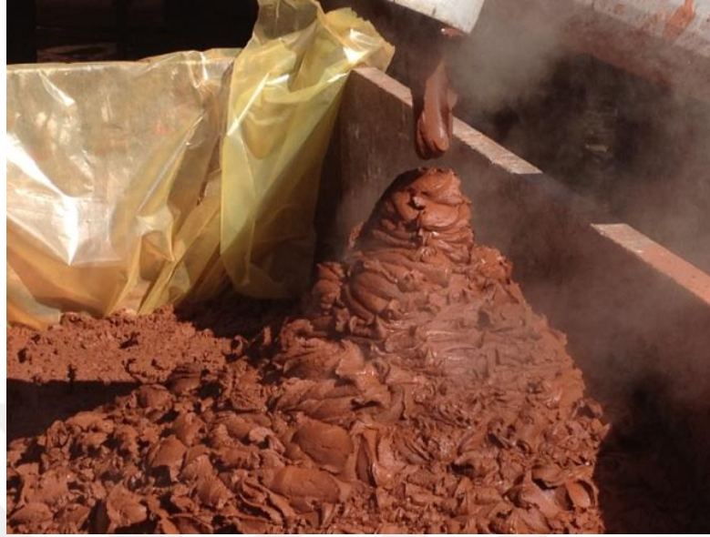
Şekil 6.27. Dekantör çıkışı katı kırmızı çamur
