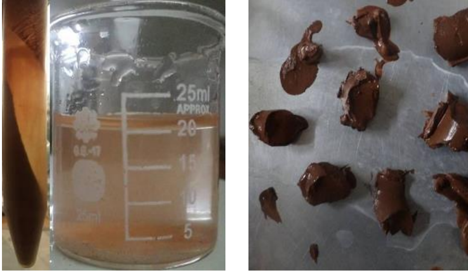
Şekil 6.24. Flokülantsız numunenin santrifüj sonrası sentrat ve kek görüntüsü
