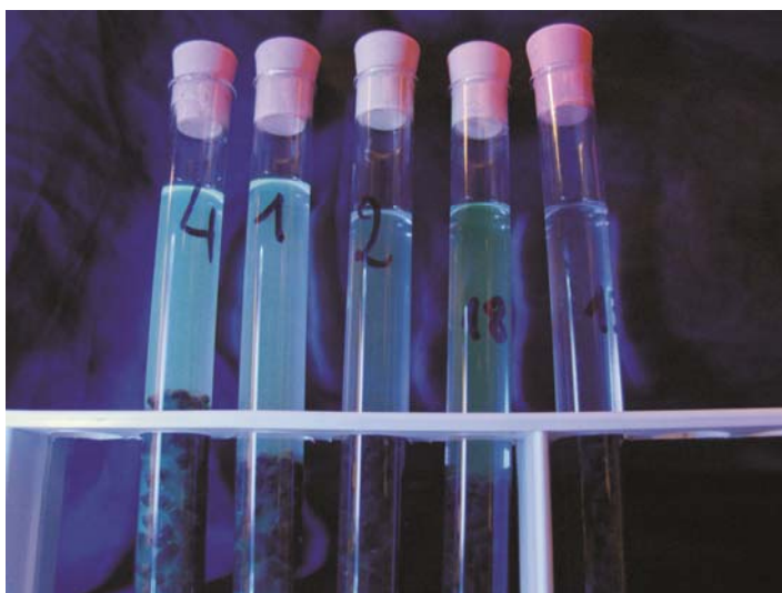
Figura 4. Analisi dei campioni in laboratorio: a sinistra, i campioni 4 e 1 sono quelli raccolti alla sorgente Niedda dopo il passaggio del tracciante, mentre il campione 2 è il “bianco” alla sorgente Niedda; a destra il campione 18 è quello positivo prelevato a Grava del Poeta, mentre il campione 13 è il “bianco” (foto N. DAMIANO).
