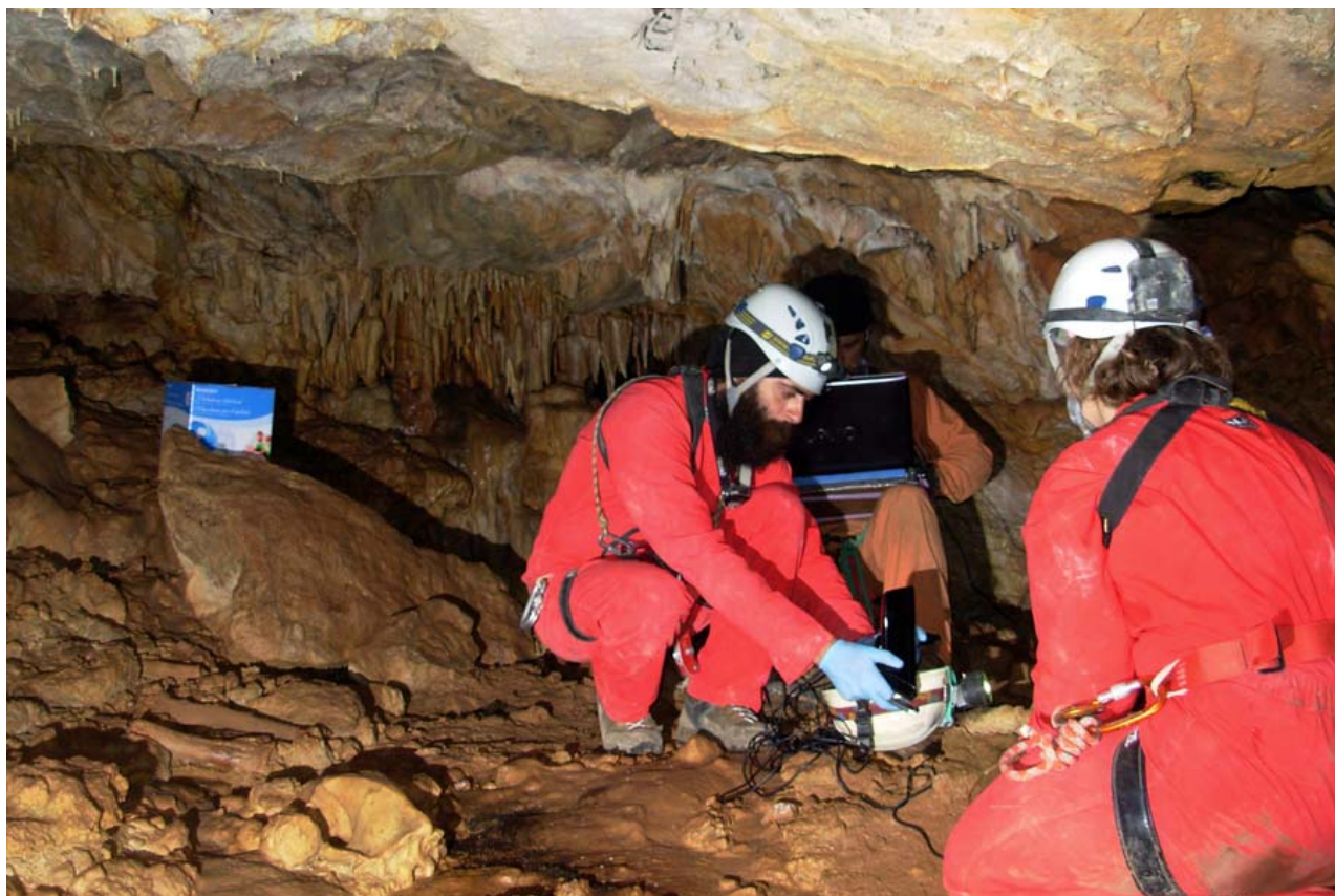
Figura 1. Operazioni di rilievo con il sensore Kinect. In basso a sinistra è possibile vedere il teschio concrezionato di Ursus spelaeus , mentre in alto a sinistra una delle scatole utilizzate come marker. Foto: P. BARTOLINI.
