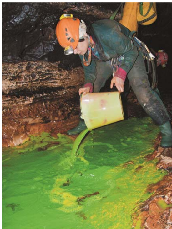
Figura 2. Fase dell'immissione del tracciante nel sifone di valle della Grotta del Falco (foto N. DAMIANO).
