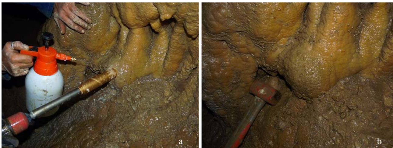
Figura 4. a: campionamento di una carota da una colata ; b: mimetizzazione del foro a campionamento avvenuto.
