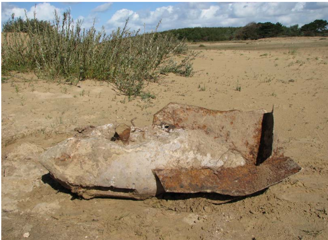
Afb. 5.6 Duitse oefenbetonbom uit de Tweede Wereldoorlog. Precies even groot en zwaar als de echte brisantbom uit die tijd. De rechthoekige uitsparingen rondom deze bommen bevatten een aantal glazen buisjes, die waren afgedekt met een laagje gips en een plankje. Het buisje bevatte een chemische vloeistof die, als de bom de grond raakte door de klap opensprong en contact maakte met de zuurstof in de lucht. Daardoor ontstond een rookwolk die aangaf waar de bom gevallen was. Zodoende kon de piloot zien of hij goed gemikt had.
