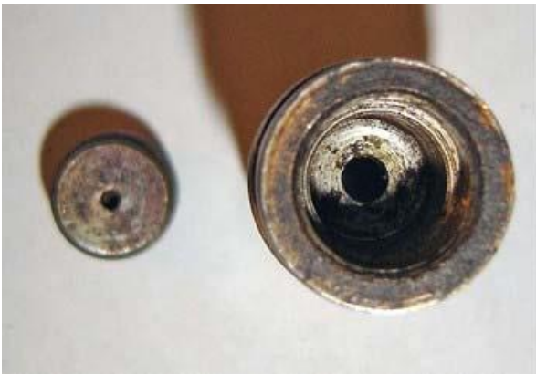
la parte posteriore con il tracciante rimosso (a sinistra), è visibile il foro che comunicava con il pellet e permetteva l'autodistruzione
