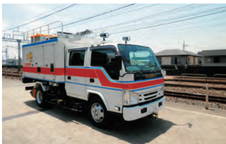
架台を格納した電気検測車
