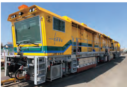
レールの表面を削るレール削正車
