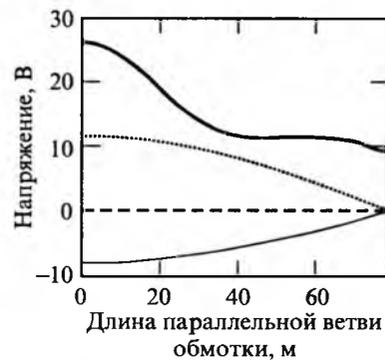
Рис.4. Распределение напряжения по длине параллельной ветви для разных моментов времени: — —  $t = 5 \cdot 10^{-6}$  с; .....  $t = 15 \cdot 10^{-6}$  с; - - - -  $t = 35 \cdot 10^{-6}$  с; — · —  $t = 3 \cdot 10^{-4}$  с
