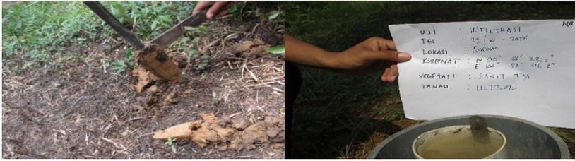
**Gambar 4.10.** Pengambilan Sampel Tanah dan Pengukuran Infiltrasi di Titik 3A
