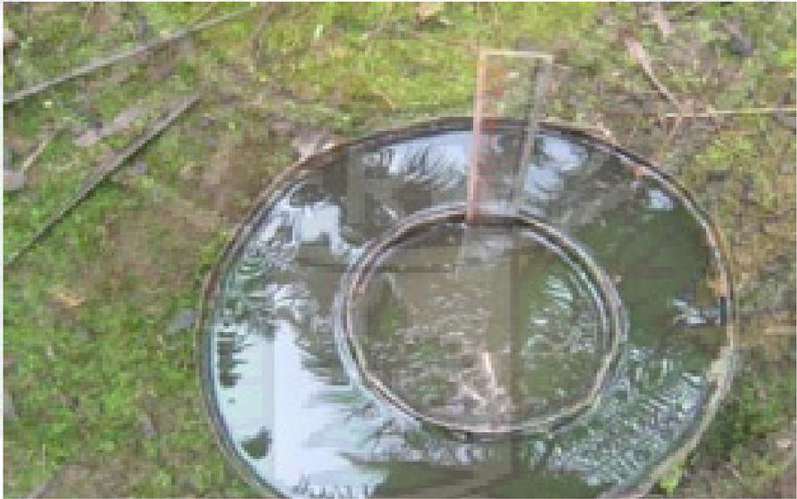
**Gambar 3.2** Pengukuran Infiltrasi
