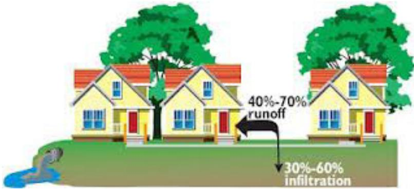
**Gambar 2.4** Prosentase Laju Infiltrasi dan Run off Pada Kawasan Permukiman
