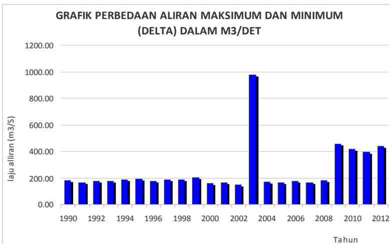
**Gambar 1.5** fluktuasi selisih debit air sungai Siak maksimum (Q<sub>mak</sub>) dengan minimum (Q<sub>min</sub>) selama 22 tahun (1990-2012).
