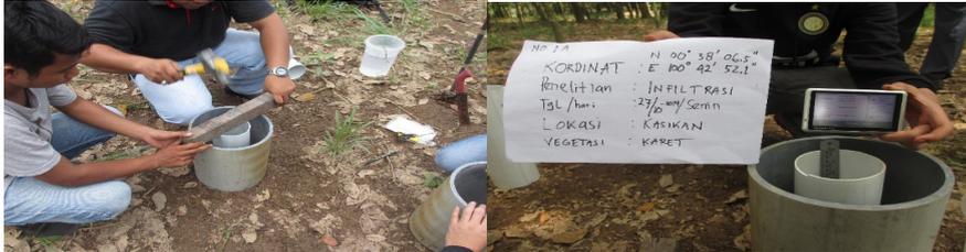
**Gambar 4.7.** Instalasi dan Pengukuran Infiltrasi di Titik 1A
