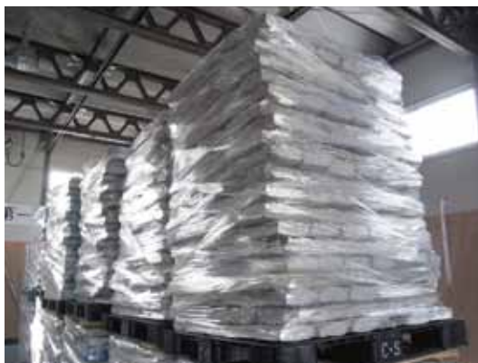
溶解・圧縮した発泡スチロールのインゴット
