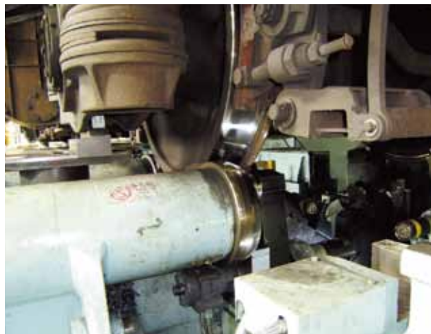
車輪の削正状況
