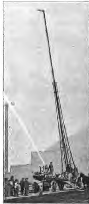
Новая пожарная труба въ Санъ-Франциско. Труба, выдвигнутая на высоту 76 футовъ и выбрасывающая 190.000 литровъ воды въ минуту.
