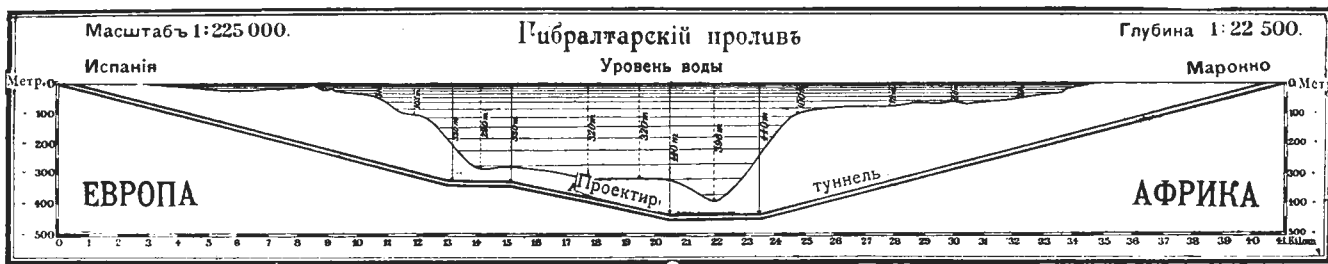
Профиль проектируемого туннеля под Гибралтарским проливом.
