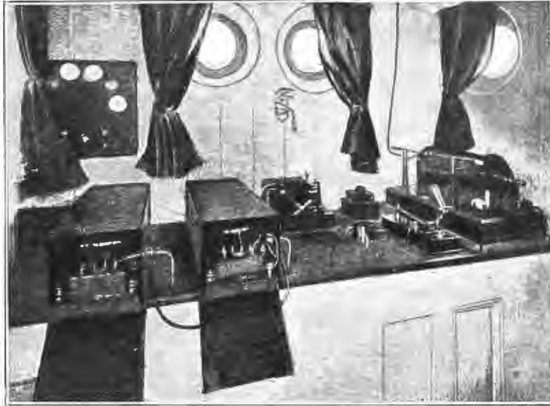
Океанская газета. Аппараты, воспринимающіе для газеты депеши по беспроводному телеграфу Маркони. По фот. авт. «Нивы».
