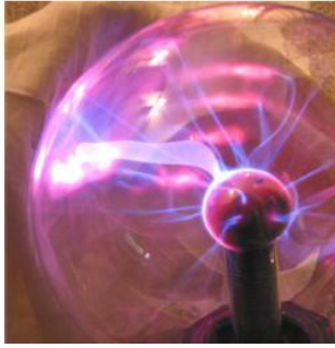
Gambar-4 Corona Discharge pada Bola Kaca
