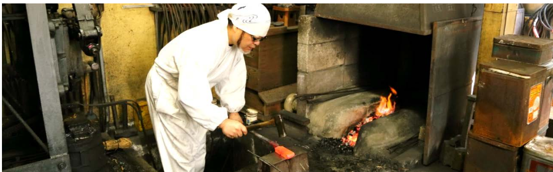
山村氏の弟子である茂木一廣氏が、硬軟の鉄を合わせて鍛錬しているところ
