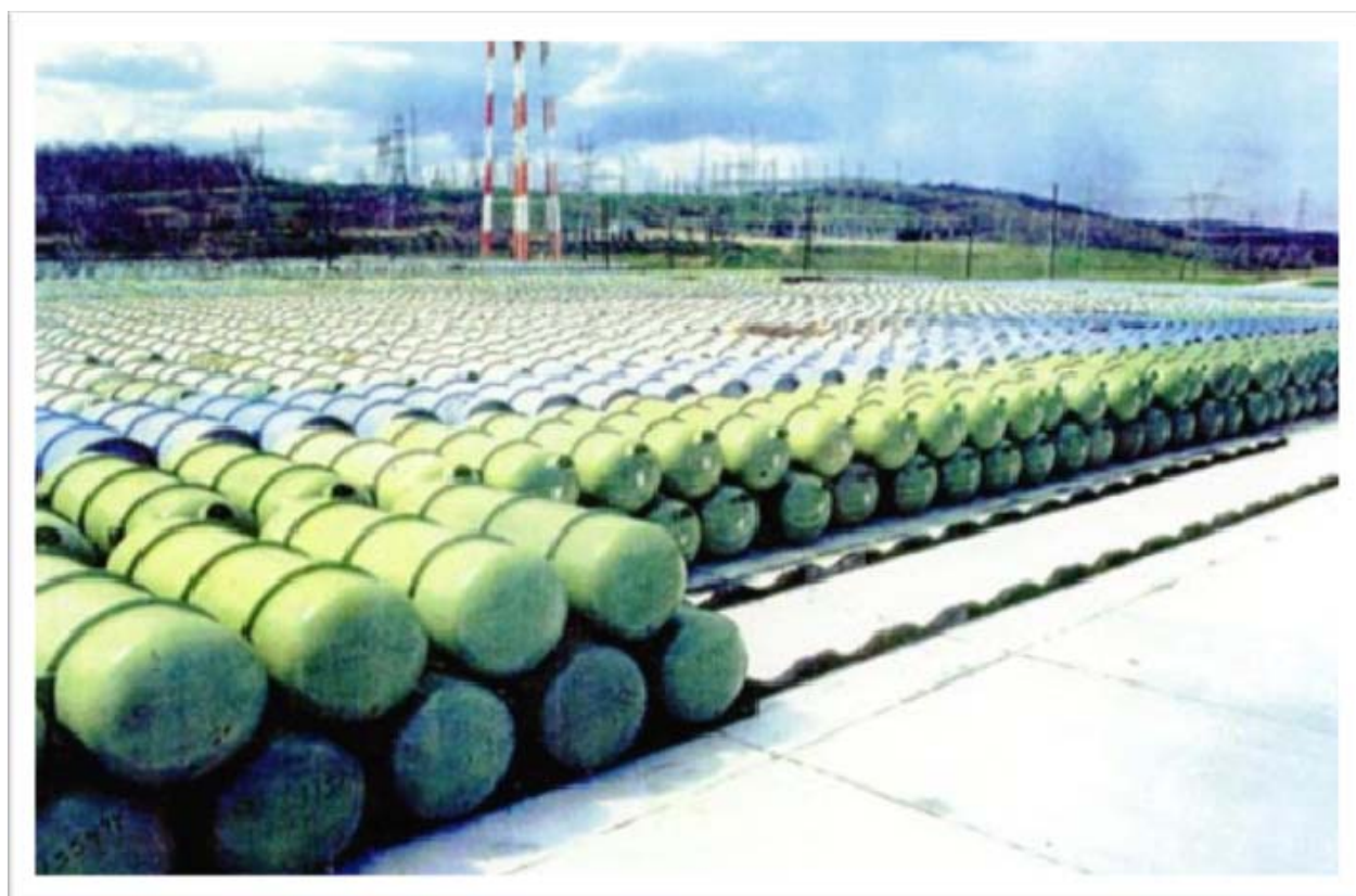
Склад контейнеров с ОГФУ в Портсмуте (США)
