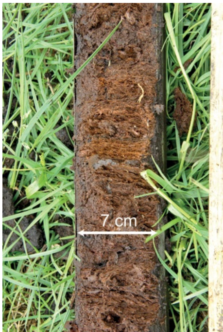
afb. 3.10 Boorkolom met veenmosveen Een deel van een boorkolom van boring 101 met daarin goed geconserveerd veenmosveen met de kenmerkende gelaagdheid.
