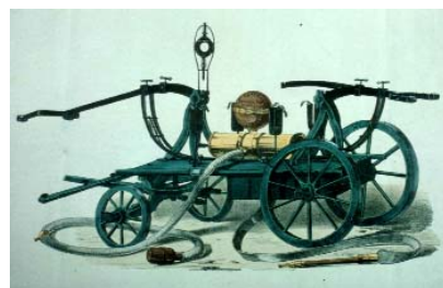
Bild 18: Zeichnung der Patent-Saugfeuerspritze von Christian Heinrich Kurtz, 1856
