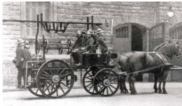
Bild 34: Erste Gasspritze der Berufsfeuerwehr Stuttgart von der Firma Heinrich Kurtz, hergestellt im Jahr 1908
