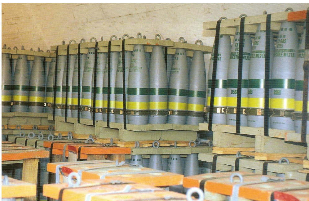
Fig. 2-1. 155 mm kemisk artilleriammunition med VX-gas.
