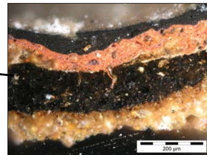
Abb. 10: Querschliff der Fassungsprobe vom Gewand des Bischofs. (Interpretation und Erläuterung im Anhang: Probe R 8, Seite 123 f)
