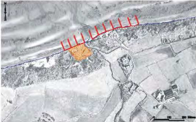
Aménagements avec des fascines de 80 mètres de longueur
