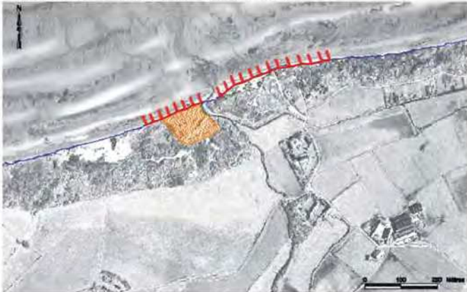
Aménagements avec des fascines de 80 mètres de longueur
