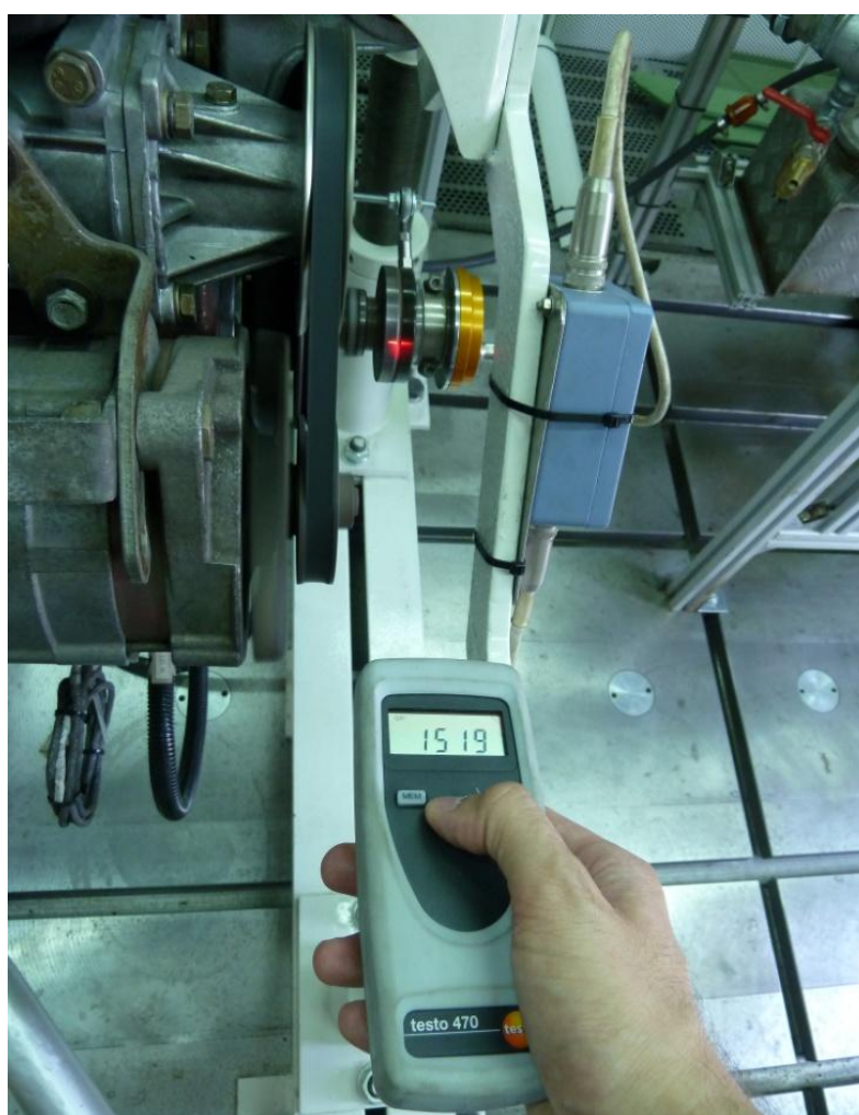
Slika 9.15. Mjerenje brzine vrtnje motora laserom
