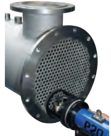
Automatisiertes Schweißen des Rohrendes und 100% Kontrolle.
