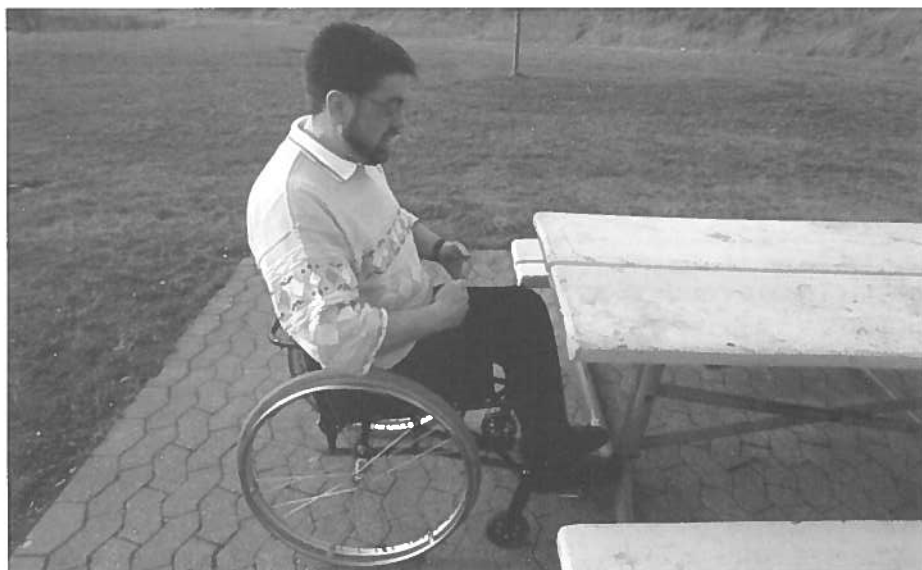
Det er tit de små marginaler, der er afgørende for om løsningen er handicapegnet. Her er bordbenet for tæt på bordenden, med det resultat, at kørestolsbrugeren knap nok kan nå bordet. Foto: Lene Storm.
