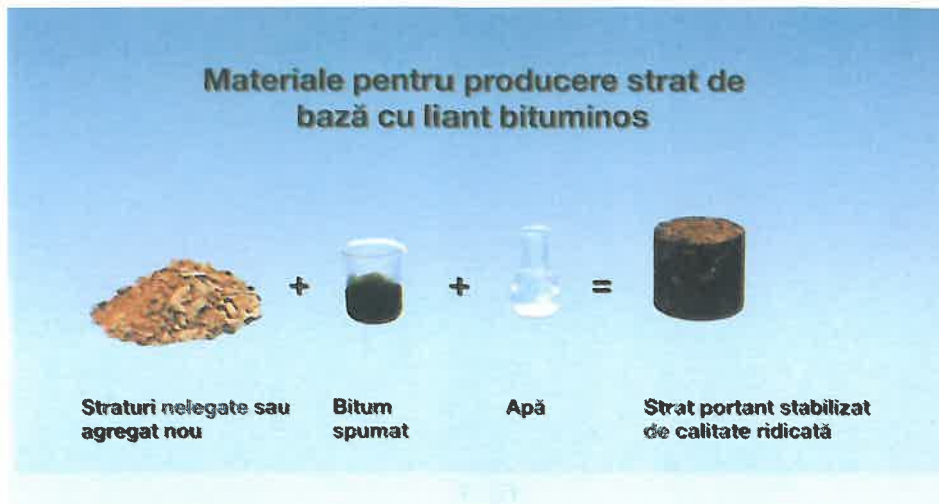
Ilustrat în laborator: material original, aditivul și corp de probă rezultat
