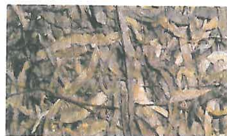
Fibrele noului produs GREENFIX-F 3 Covamat Plus sunt rezistente la foc, conform DIN 4102-1
