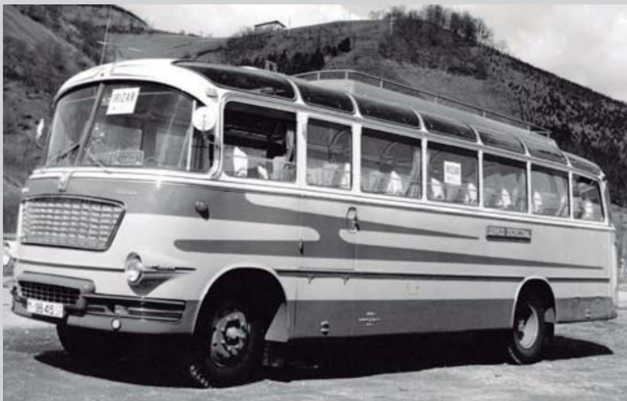
464 Autocares Samarrentzat Leyland bastidorearen gainean (Comet seriea) egindako birkarroztatze-lana, 1960 Trabajo de recarrozado sobre bastidor Leyland, en su serie Comet, para Autocares Samar, 1960
