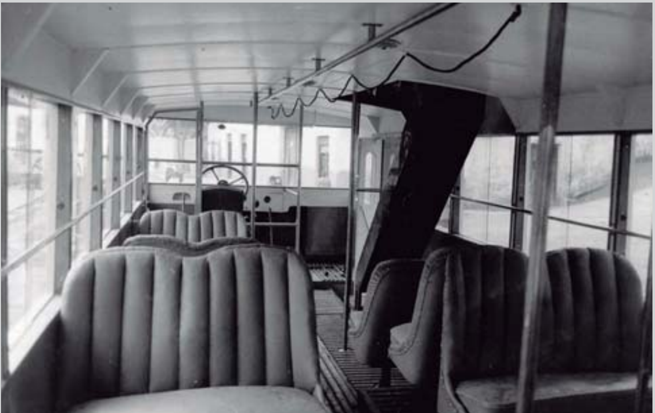
431 - 432 MAN bastidorearen gainean jarritako egitura erdi-metalikozko karrozeria, haren aurrealdea errespetatuz Carrocería de estructura semimetálica sobre bastidor MAN, respetando su parte frontal
