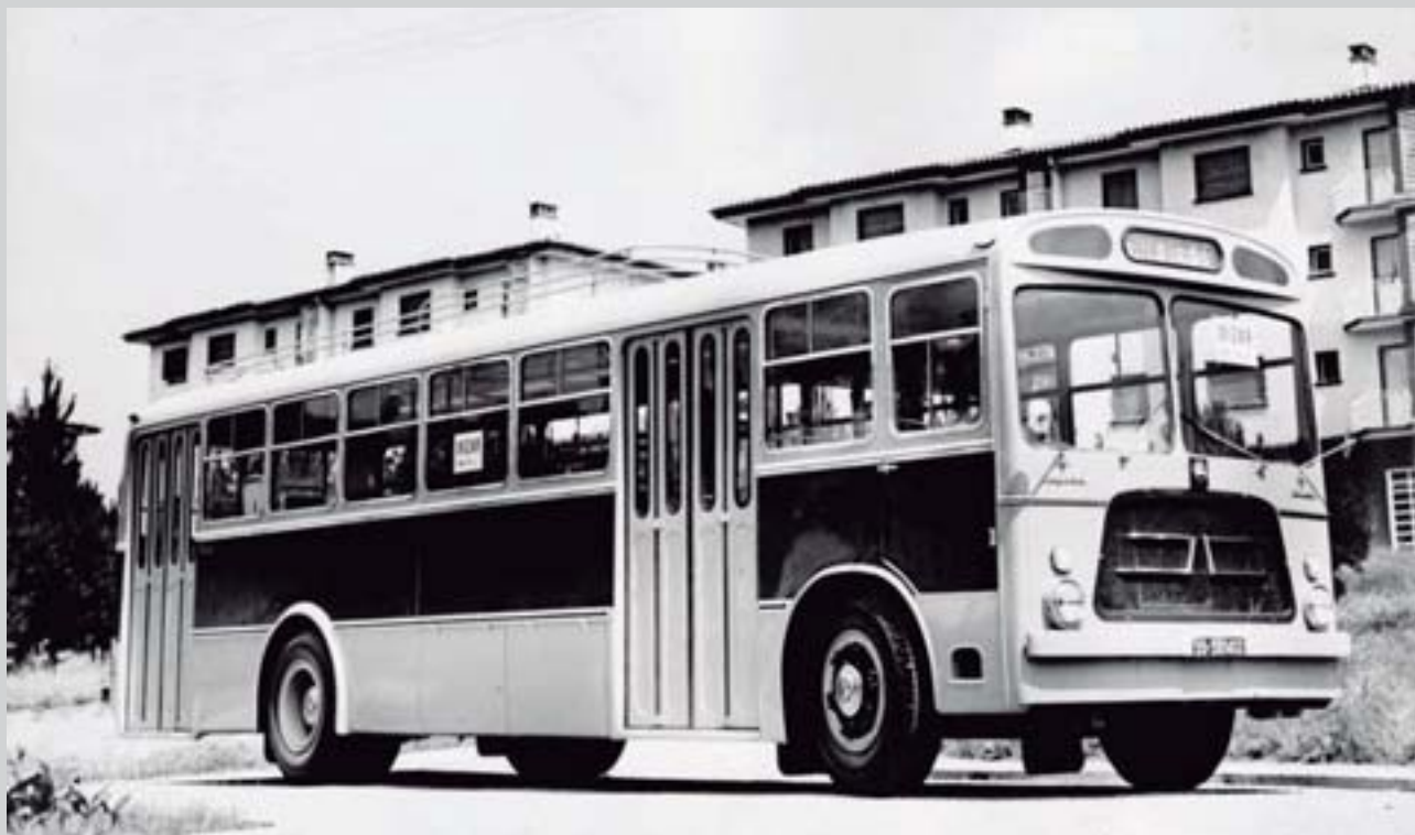
470 Pegaso bastidorearen gainean Garayar Hnos.entzat karrozatutako hiri-barruko autobusa Urbano sobre bastidor Pegaso, carrozado para Garayar Hnos.
