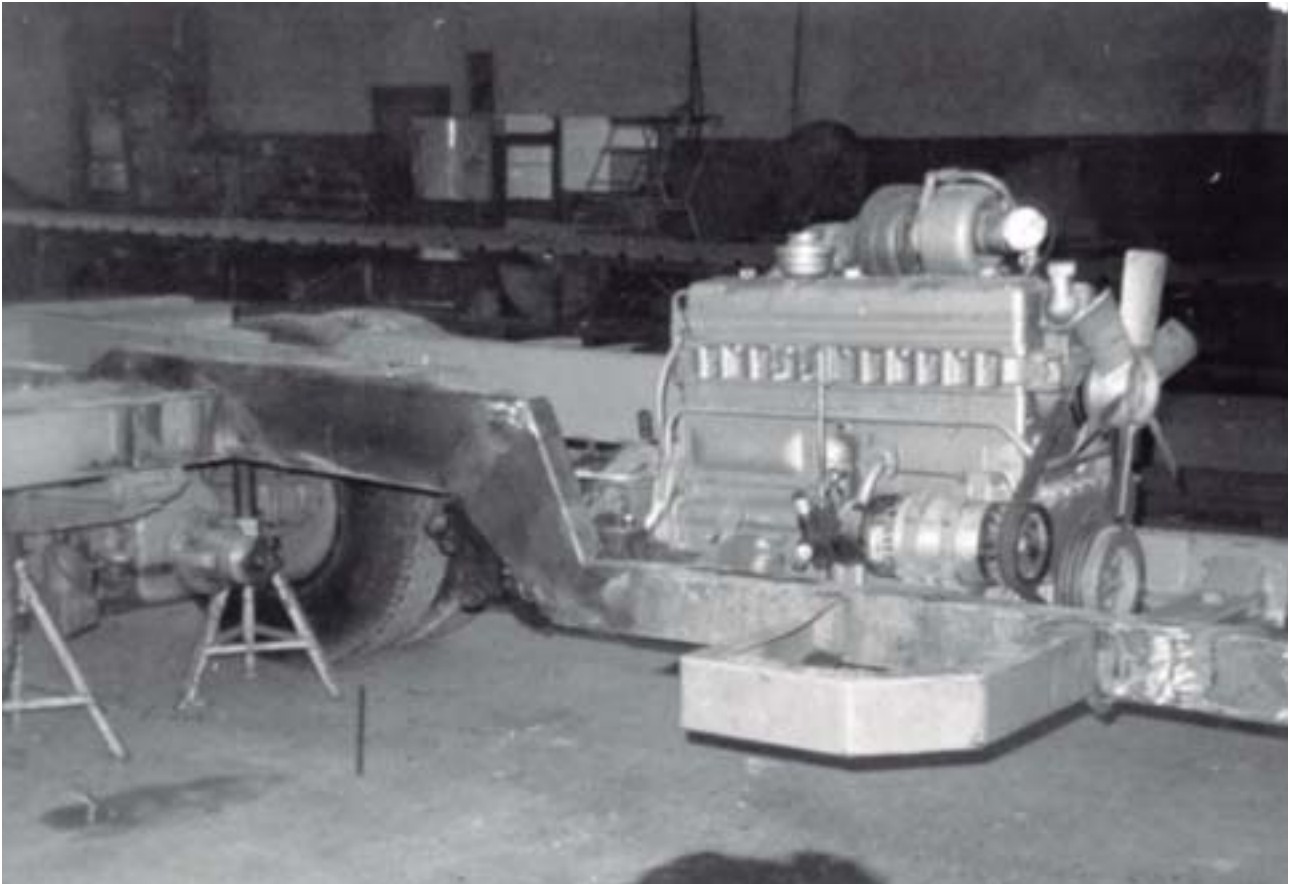
530 DAF txasis aldatuaren atzealdea, motorra instalatu ondoren Parte trasera del chasis modificado DAF, tras la instalación del motor
