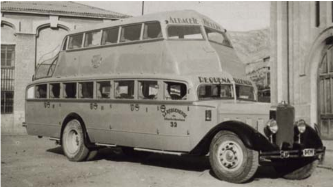
365 Hispano-Suizako T-69 txasis gainean F.Miró Sancho karrozatutako autobusa Autobús carrozado por F. Miró Sancho sobre chasis T-69 de Hispano-Suiza
