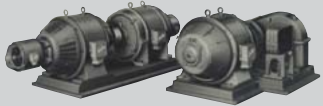
199 Ward Leonard multzoaren ikuspegi orokorra eta kalandra bat abiarazteko. Vista general del grupo Ward Leonard y motor para accionamiento de una calandra
