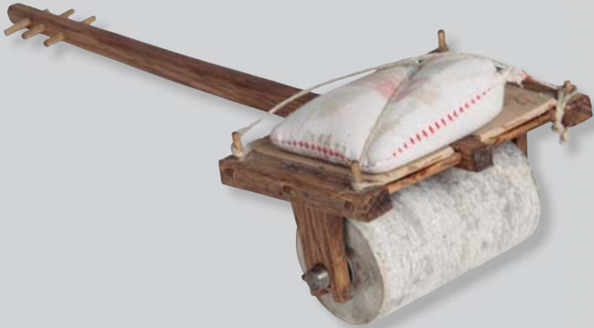
352 Carro transformado en apisonadora, mediante el empleo de un rodillo con sobrecarga añadida
