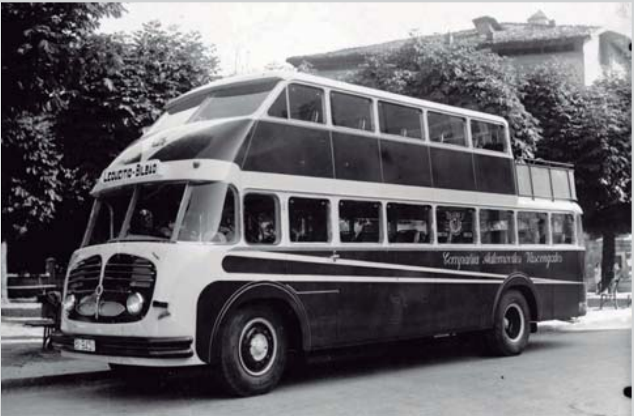
565 Egitura metalikoa duen lehen karrozeria, 1954 Primera carrocería de estructura metálica, 1954
