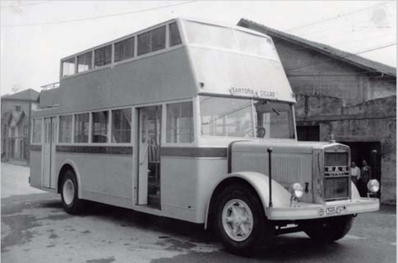
431 - 432 MAN bastidorearen gainean jarritako egitura erdi-metalikozko karrozeria, haren aurrealdea errespetatuz Carrocería de estructura semimetálica sobre bastidor MAN, respetando su parte frontal
