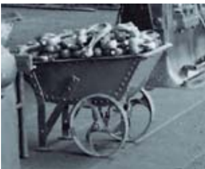
121 Pablo Irizarrek errematxe bidezko junturak erabiliz egindako eskorga Carretilla con uniones a base de remaches fabricada por Pablo Irizar
