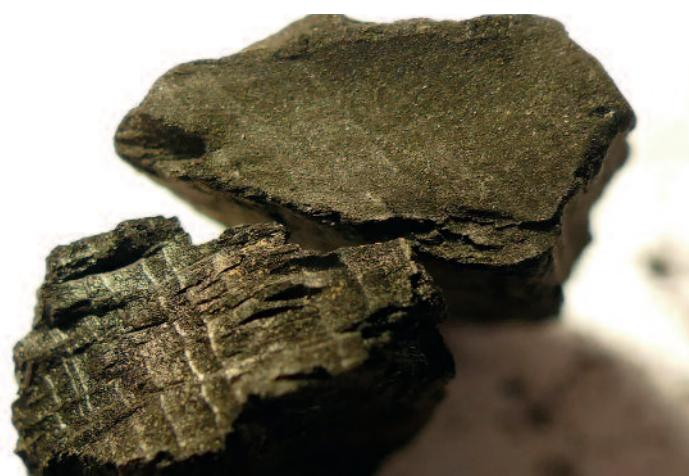
Ryc. 6. Powiększony obraz powierzchni węgli z próbki N8/2012 — przekroje poprzeczne
