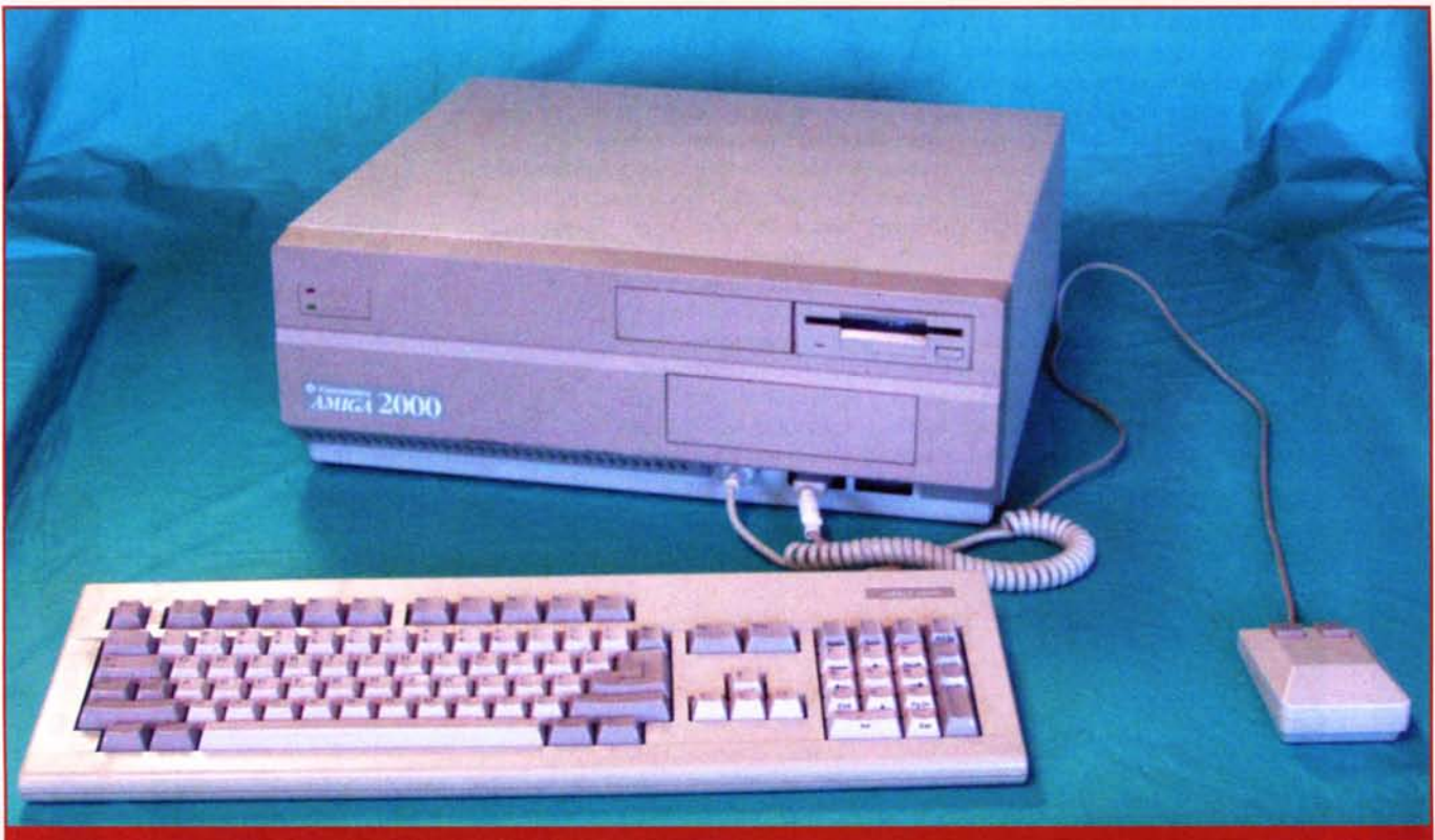
Увеличенный в высоту корпус Amiga 2000 позволял установить сразу несколько плат расширения. Именно поэтому компьютер пользовался популярностью на рынке обработки видео.
