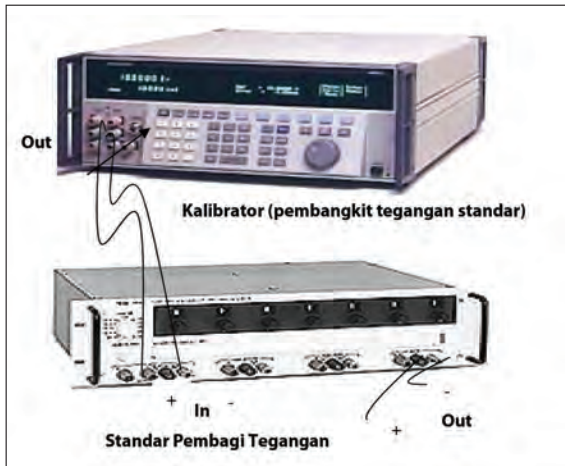
Gambar 4.10 Rangkaian Kalibrator dan Pembagi Tegangan
