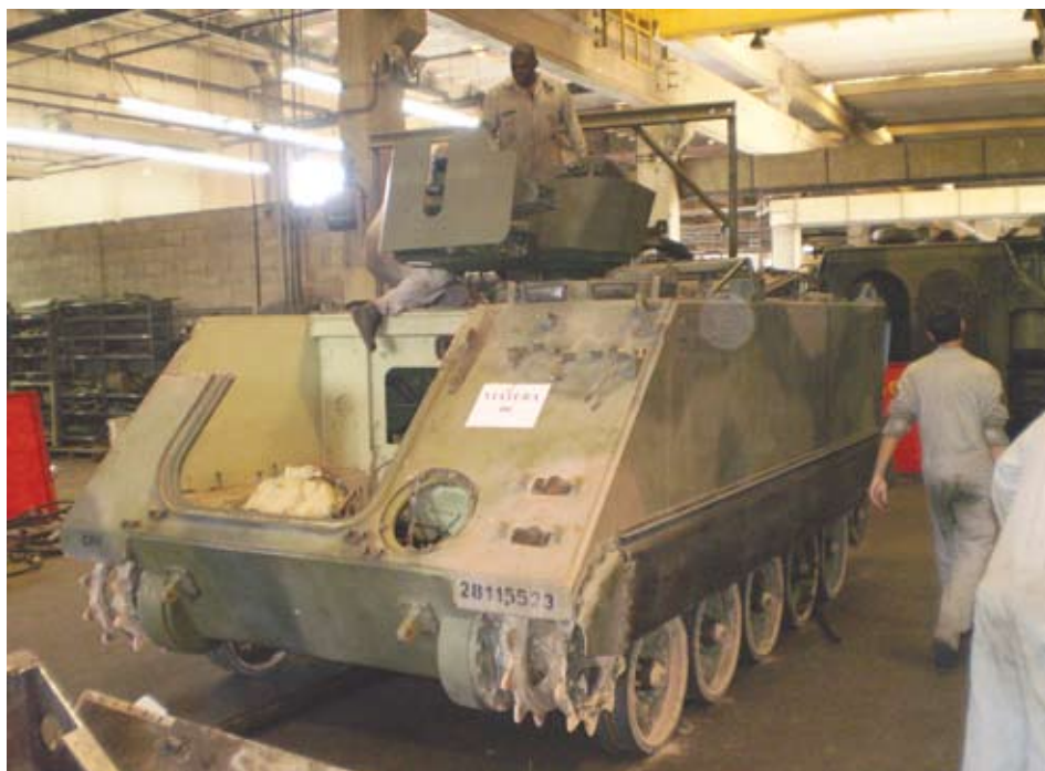
Modernização das viaturas M113A1 no Centro de Reparos e Suprimentos Especiais do CFN.
