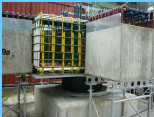
隔震墊與結構樑柱系統接合示意圖
