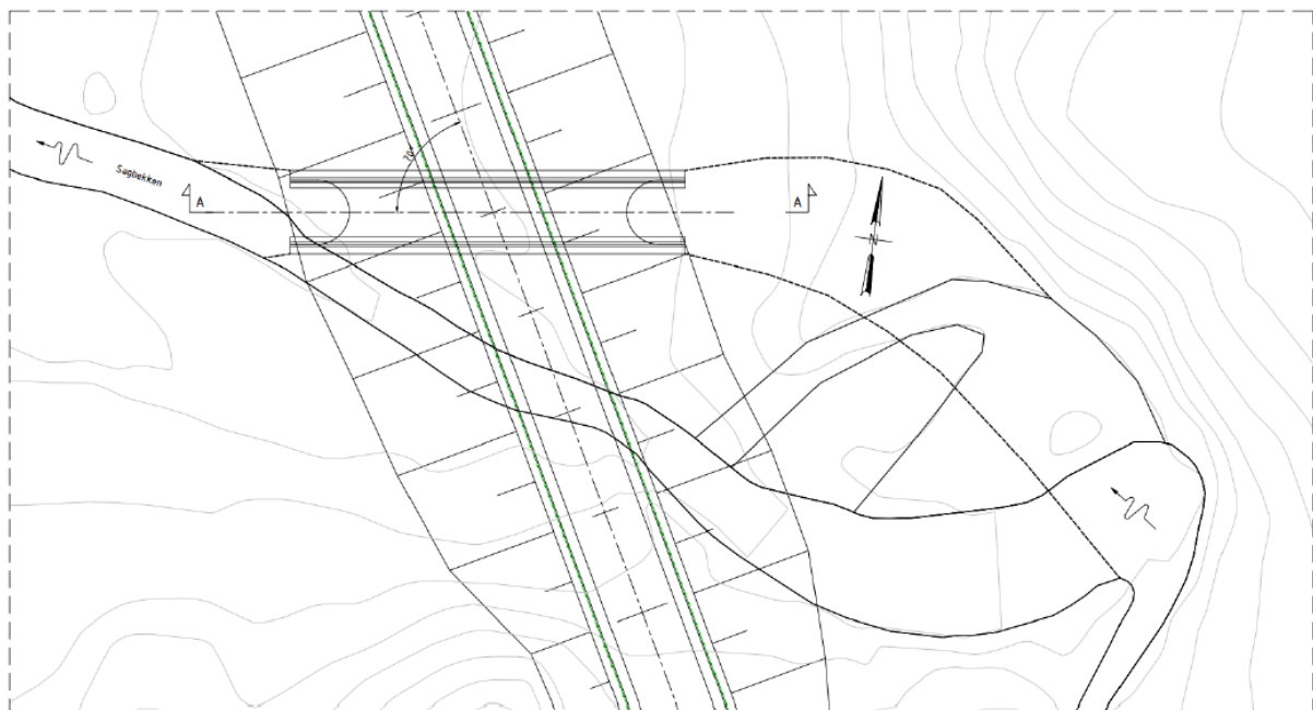
Figur 13: Justering av bekkeløpet ved Sagbekken
