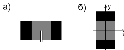
Рис. 6. Схема электродов для формирования спиральной фазовой пластинки: а) верхняя подложка; б) нижняя подложка.
