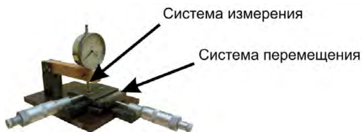
Рис. 2. Механическая система сканирования резисторов
