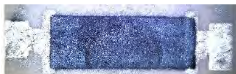
Рис. 6. Подложка с толстопленочным резистором
