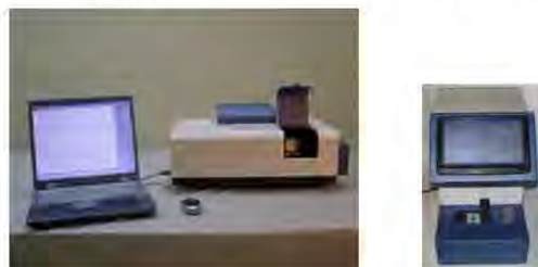
Биосенсорные тест-системы (биосенсоры) на основе полифункционального дихрометра СКД-2МУФ (слева) и трехволнового (на светодиодах) дихрометра СКД-4
