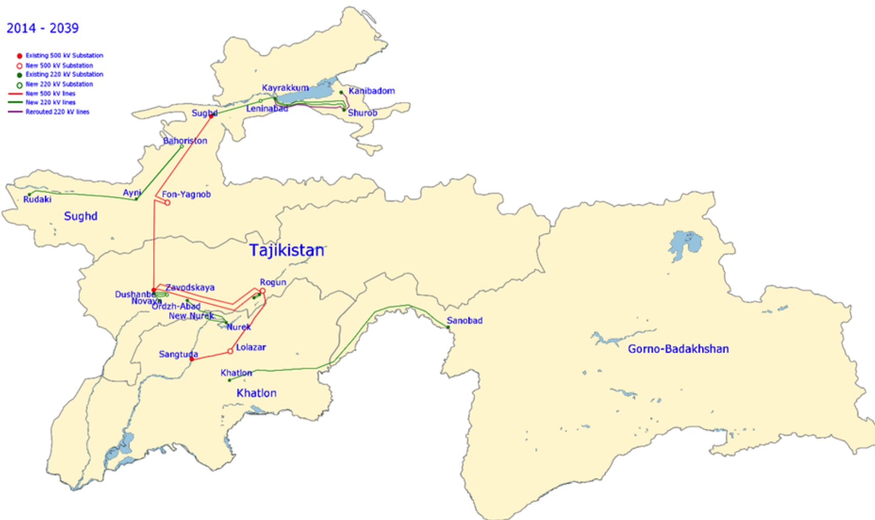
Рисунок Е - 11: Рекомендуемые линии электропередачи 500 кВ и 220 кВ для плана расширения с Рогунской ГЭС (2014-2039 гг.).
