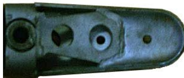
Рисунок 2 – Конструкция уширителя траков
