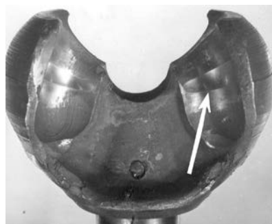
Рисунок 3 – Износ вилки шарнира равных угловых скоростей
