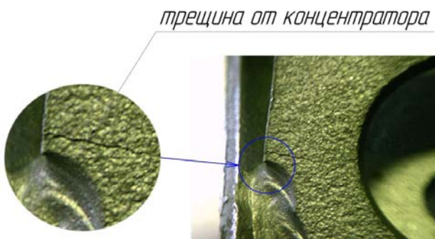
Рисунок 4 – Разрушение по соединению упор-уширитель
