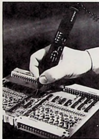
Bild 1: Prüfstift für Digital-schaltungen in der Anwendung (Siemens-Pressbild)
