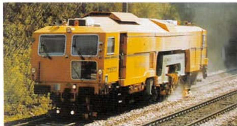
09-3X La única máquina bateadora en el mundo para el bateo de tres durmientes a la vez
