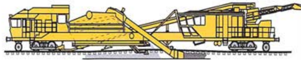
Máquina desguarnecedora con una criba RM 80
