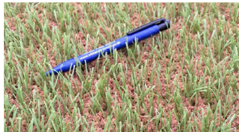
Rys. 19 System dywanowej murawy hybrydowej z korzeniami wnikającymi w podłoże dywanu
