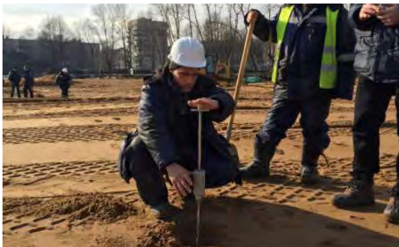
Rys. 5 Testowanie zwięzłości warstwy nośnej murawy
