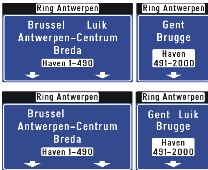
Figuur : Voorbeeld van een variabel bestemmingsbord waarbij de namen van de bestemmingen kunnen worden gewijzigd (bron: VVC)
