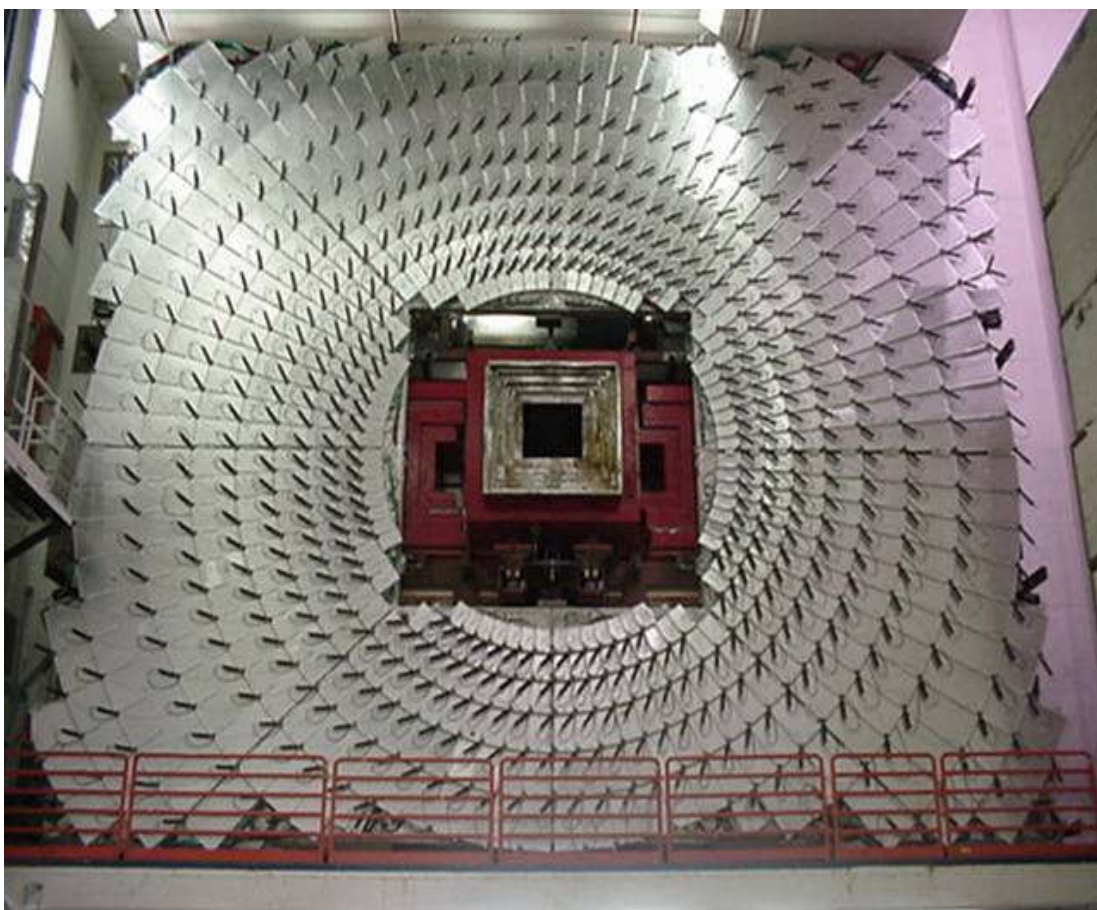
Рис.2.2. Фотография слоя С триггерных сцинтилляционных счетчиков передней мюонной системы.
